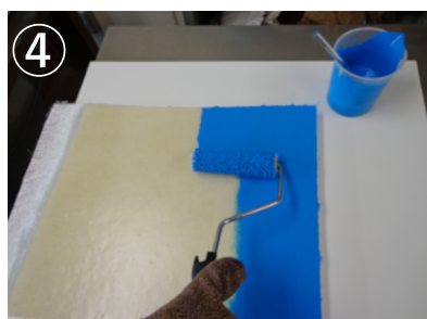
④ ゲルコートトップを塗布 (PC-815TP NPG708※硬化剤使用)
