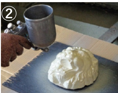
② 直ちにスプレー塗装 口径2.5Φmm ※希釈：スピリットシンナーで 0～15%程度
