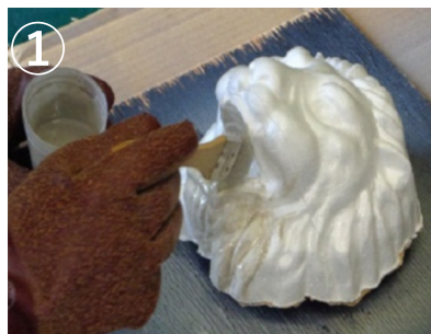
① 促進剤を添加攪拌し、その後硬化剤を添加攪拌、刷毛で表面を塗布 ※刷毛で先に塗るとピンホールができてにくい
